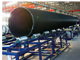
下水用の排水パイプ
