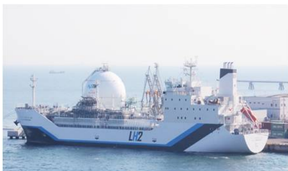
神戸液化水素荷役実証ターミナルに着岸した 液化水素運搬船
