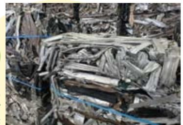
使用済みのアルミ缶を回収し、異物を除去し、溶解・成分調整を行った再生塊をメーカーに供給することで、再度アルミ缶に再生させています。同様に、窓枠(サッシ)も、リサイクルを行っています。
